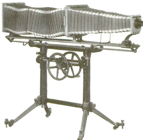
Figura 7: Màquina fotogràfica per a plaques de vidre amb trípode de ferro. (a): Màquina conservada al Museu de Geologia de Barcelona. (b): Màquina que utilitzà Rafael de Castro en l'expedició científica espanyola a Amèrica (1862-66).
